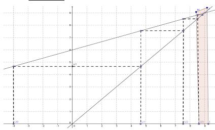
On voit clairement sur le schéma ci—contre que les valeurs de (Un) « s'agglutinent » de plus en plus dans la zone grisée .Dès que n>4 elles se rapprochent du point fixe qui est l'abscisse du point d'intersection de la droite y=x et de la courbe y=f(x) à savoir Xo = 9.
